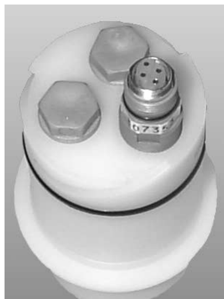
Vue de dessous du porte-électrode avec une électrode montée
