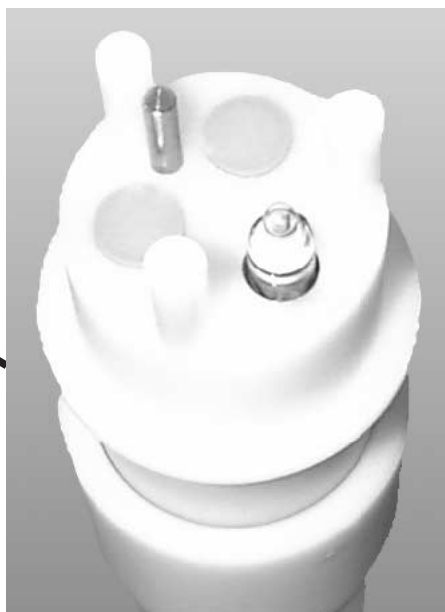
Vue de dessous du porte-électrode avec une électrode montée et la broche de compensation de potentiel
