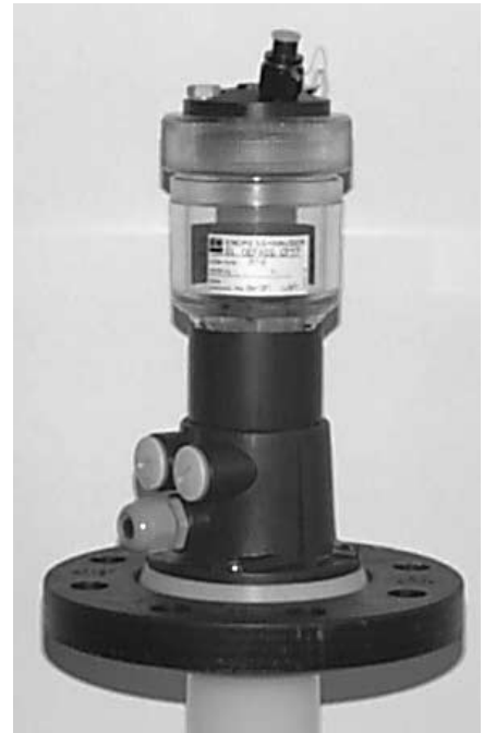
Réservoir de KCl monté sur la sonde CPA 140
