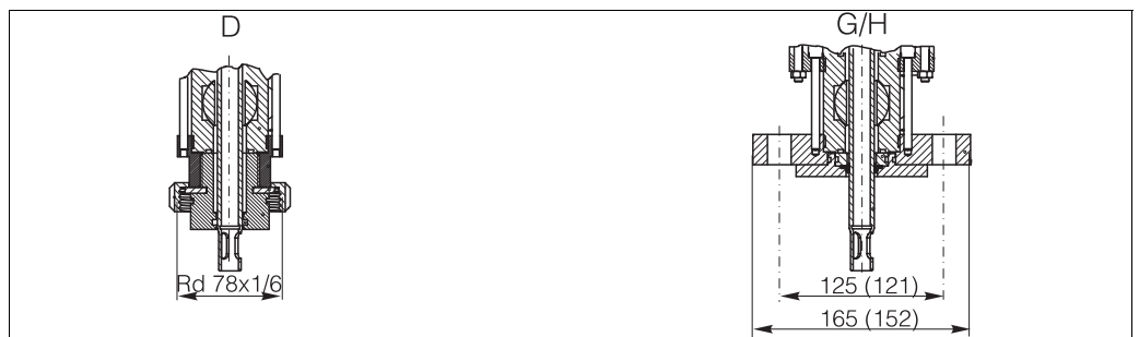
Fig. 14 : Raccords process (dimensions entre parenthèses : bride ANSI 2")
